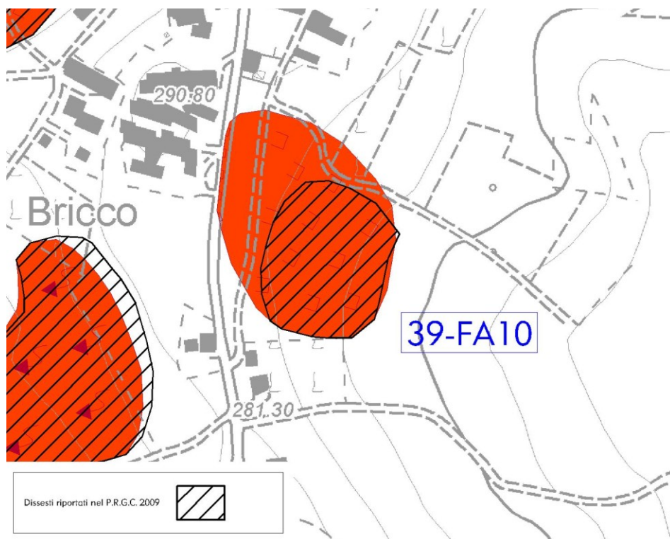
Fig. 9.2 – Particolare del fenomeno franoso 39-FA10, scala 1:5.000, in cui si evidenzia l'evoluzione del dissesto che attualmente interessa periodicamente la sede della Strada Provinciale n° 3, a differenza di quanto cartografato nel P.R.G.C. 2009.
